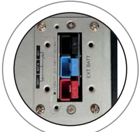
Conector de banco de baterías
